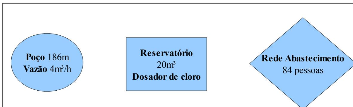
Figura 4.9 - Fluxograma do Sistema de Abastecimento.
