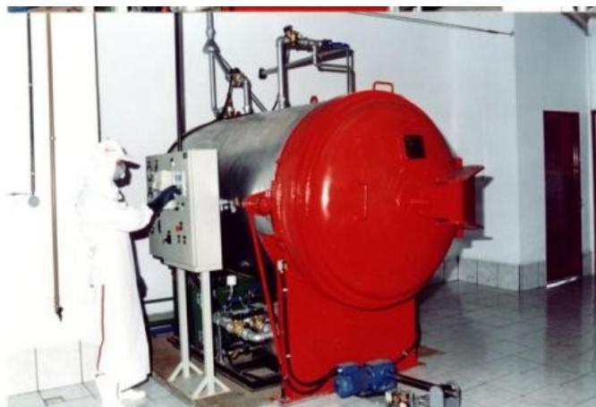
Figura 6.19 - Autoclave em operação. Fonte (Tucano)
