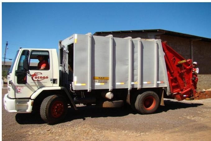
Figura 6.7 – Caminhão compactador utilizado na coleta.
