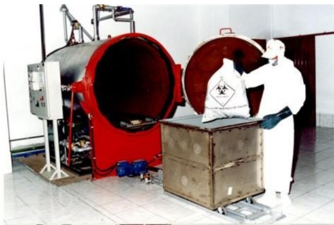
Figura 6.17 - Colocação dos resíduos no Autoclave. Fonte (Tucano)
