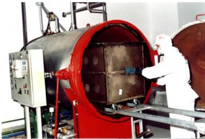
Figura 6.18 - Colocação dos resíduos no Autoclave. Fonte (Tucano)
